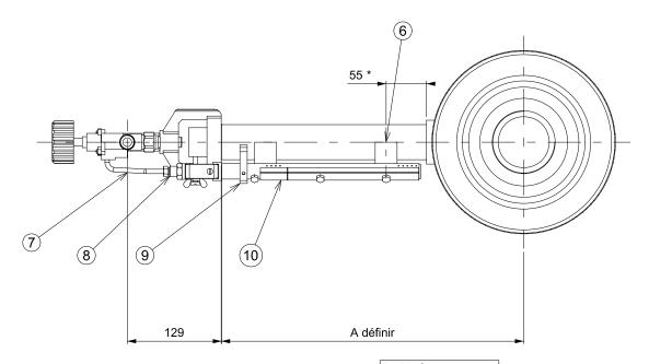
\* : Ajusté avant soudure selon lg de la veilleuse
