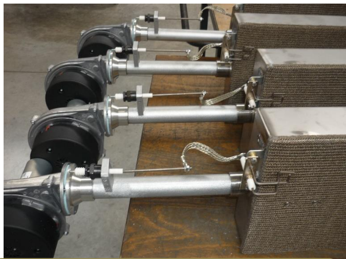
Brûleur radiant à Air Soufflé de 30 kW de surface rayonnante 1 face de 500x250mm.
