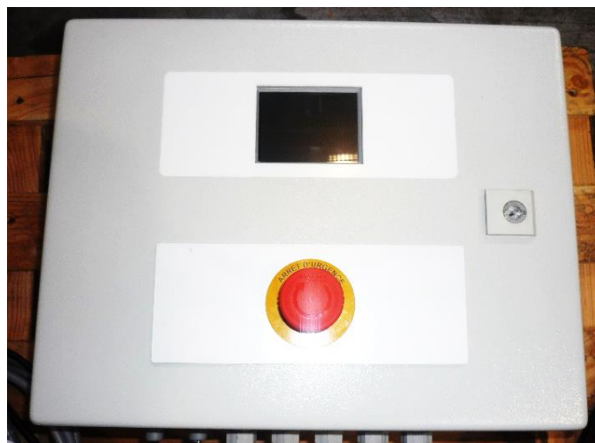
Coffret de commande avec 1 carte ET35ASBP pour 1 Brûleur radiant à Air Soufflé modulant.
