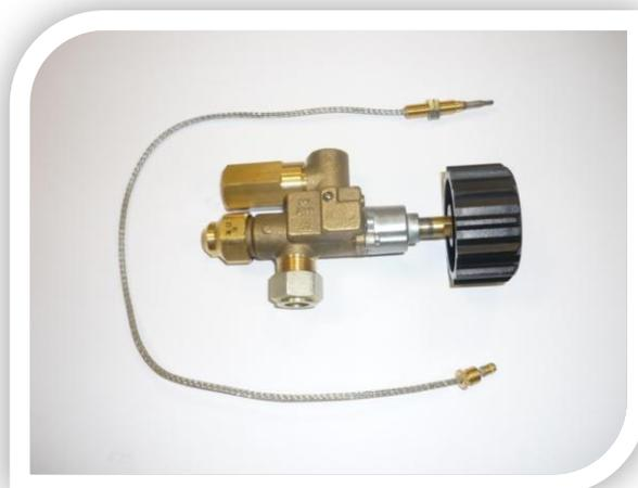
Ce robinet est prévu pour alimenter en gaz un brûleur fonctionnant à la pression maxi de 65 mbar, de 25 kW Hi maxi, avec une sécurité de coupure de gaz intégrée (technologie du thermocouple). Le montage sur nourrice gaz se fait par raccord à souder. Fonctionnement possible avec ou sans veilleuse.
