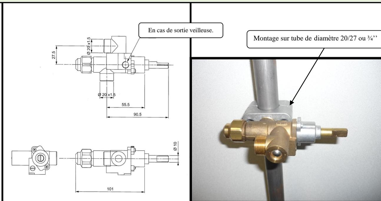
Accessoires composant un kit complet de robinetterie gaz pour fonctionnement avec veilleuse :
