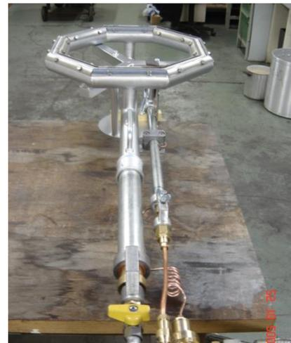
Brûleur rampe LABO de forme octogonale, éléments rampe Ø48mm à sécurité manuelle
