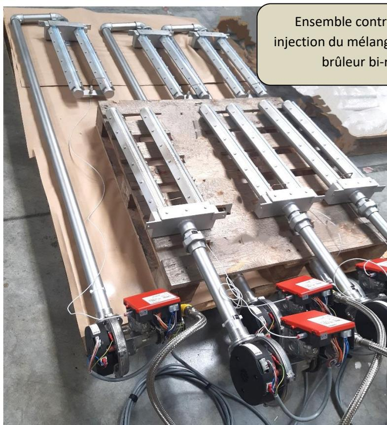
Ensemble contrôle de flamme et injection du mélange air-gaz, monté sur brûleur bi-rampe ASBP.
