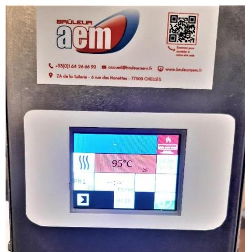
Pupitre de commande à 1 écran vertical ET35ASBP pour le contrôle d'1 brûleur à air soufflé et la régulation de température d'1 appareil de cuisson.
